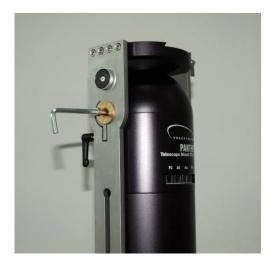
Lösen sie die Höhenklemmschrauben und drehen Sie die Gegengewichtsarme in eine horizontale Position.
