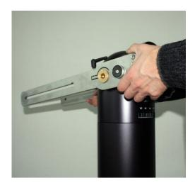
Nehmen Sie die beiden Messingadapter aus der Achse. Sie sind konisch und schauen ein wenig aus der Achse heraus. Um sie frei zu kriegen, geben Sie einen leichten Schlag mit der Hand auf die gegenüberliegende Seite. Wenn beide Messingadapter gelöst sind, nehmen Sie sie heraus und bauen das Topmount Assembly ab.
