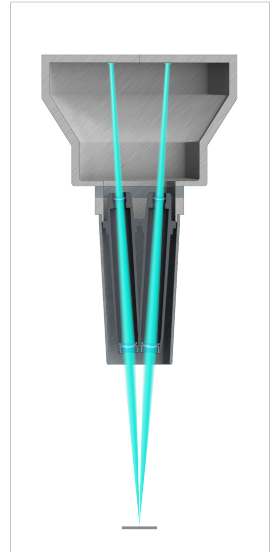
Schematischer Strahlengang eines Greenough-Stereomikroskops.
