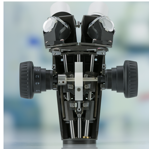
ZEISS Stemi 508 verfügt über ein nach dem Greenough-Prinzip funktionierendes optisches System mit leistungsstarkem 8:1-Zoom. Die beiden Zwillingsstubskörper sind im Winkel von 11° geneigt und liefern ein beeindruckendes Stereobild.
