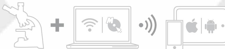
Die **MoticHUB** Technologie ist in unserer Motic Images Plus Software **integriert**, was die vorhandene verkabelte Moticam oder Ihr Digitalmikroskop (ursprünglich mit Motic Software ausgerüstet) in eine **WiFi Streaming digitale Lösung** umwandelt.
