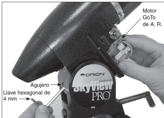
Figura 4. Colocación del motor GoTo de A. R.
