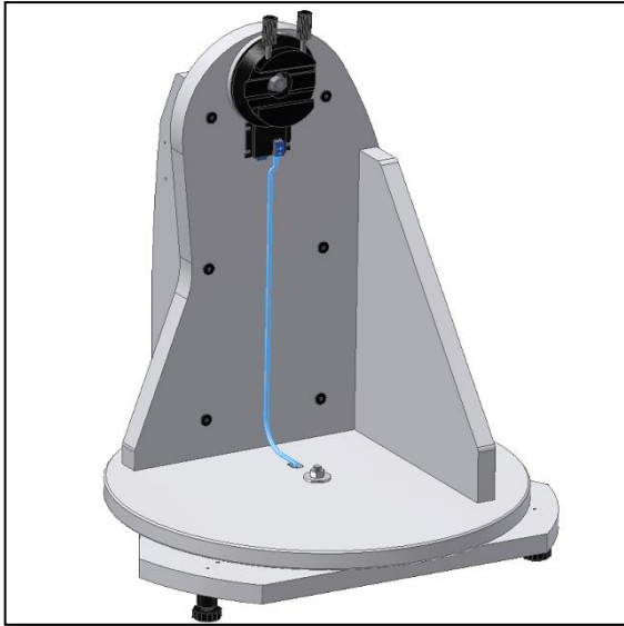
Figura 15. Monte el cable suministrado (pieza 4). El cable se conecta correctamente cuando se escucha un "clic".
