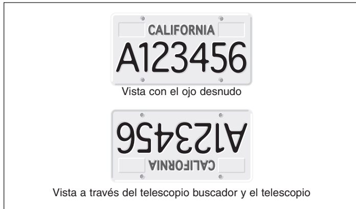
Figura 40. La vista a través de un telescopio buscador recto y un telescopio reflector aparece girada 180°. Esto se cumple para el XX12 y su telescopio buscador.
