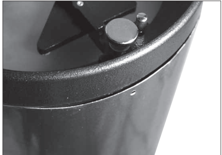
Figura 20. Localice el área del tubo que sobresale hacia fuera y evite que el anillo del extremo encaje completamente.
