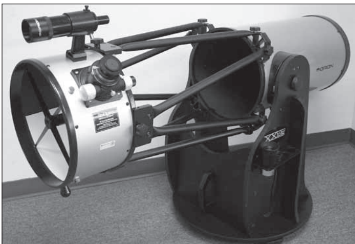
Figura 32. Esta imagen muestra el XX12 correctamente preparado para la colimación. Fíjese en el papel blanco colocado a través del enfocador y en el ángulo nivelado del tubo óptico. Lo ideal es que el telescopio apunte a una pared blanca.
