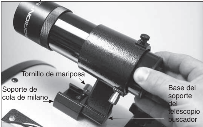
Figura 28. La base del soporte del telescopio buscador se coloca en el soporte de cola de milano y se sujeta con el tornillo de mariposa del soporte.
