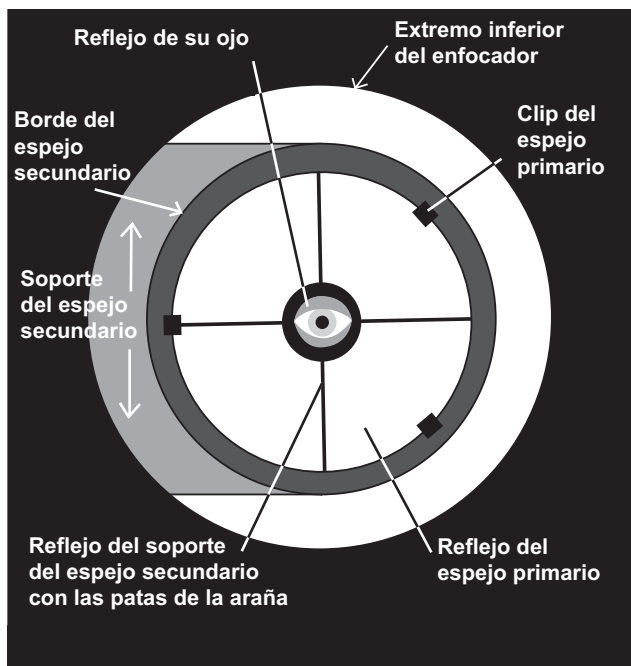
Figura 31. Colimación de la óptica. (a) Cuando los espejos estén bien alineados, la vista hacia abajo por el tubo del enfocador debería tener este aspecto. (b) Con la tapa de colimación en su lugar, si la óptica no está alineada, la vista puede ser algo parecido a esto. (c) Aquí, el espejo secundario está centrado bajo el enfocador, pero es necesario ajustarlo (inclinarlo) de modo que todo el espejo primario completo sea visible. (d) El espejo secundario está correctamente alineado, pero el espejo primario todavía necesita ajuste. Cuando el espejo primario está correctamente alineado, el "punto" se centra, como en (e).
