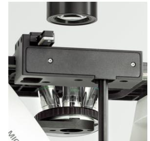
L'applicazione delle manopole di messa a fuoco x/y è possibile a destra e a sinistra
