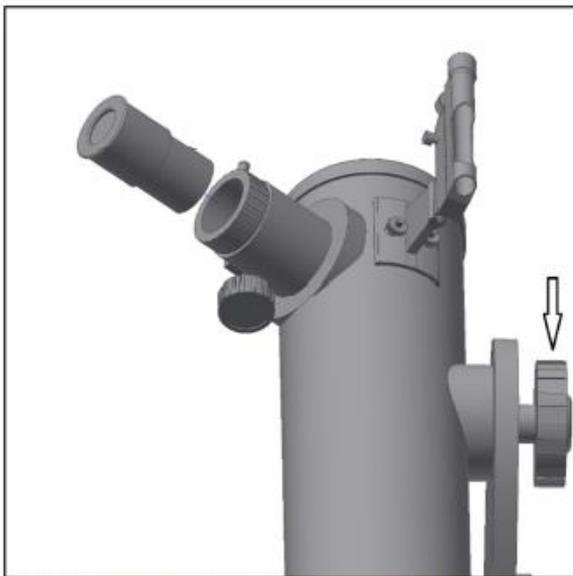
Figure 4 : Insérez l'oculaire grossissant le moins (H 20 mm)
