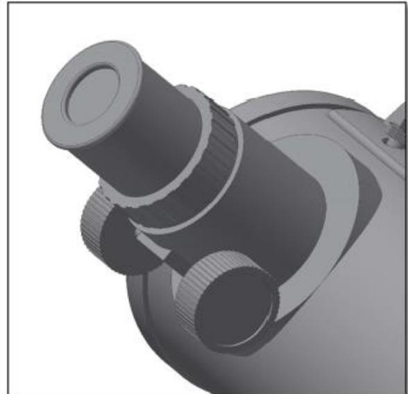
Figure 5 : Tournez la vis sur le porte-oculaire pour bloquer l'oculaire
