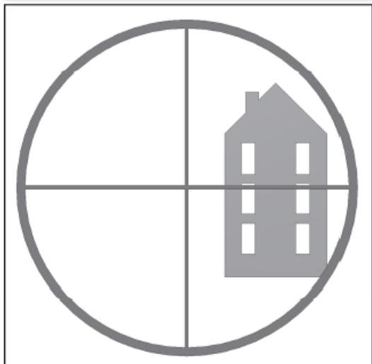
**4.2** En regardant à travers le viseur on peut voir le même bâtiment, mais la cheminée n'est pas centrée. On ajuste alors la position avec les deux molettes (voir schéma ci-dessous). Le point rouge se déplace lentement. Recommencez progressivement jusqu'à obtenir un résultat satisfaisant.
