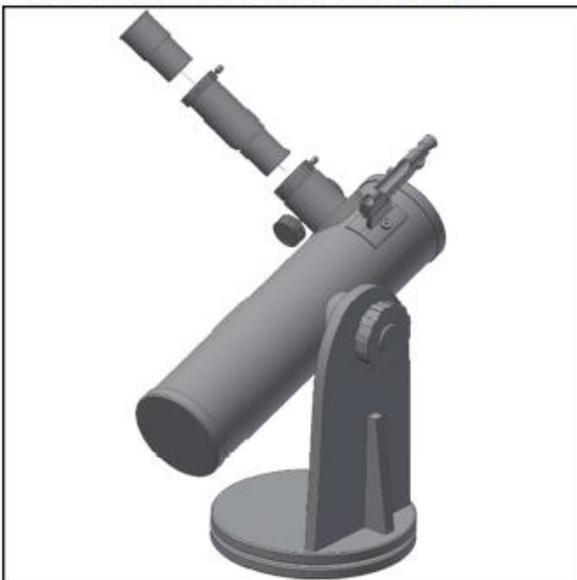
Figure 6 : Utilisez la lentille de barlow avec l'oculaire
